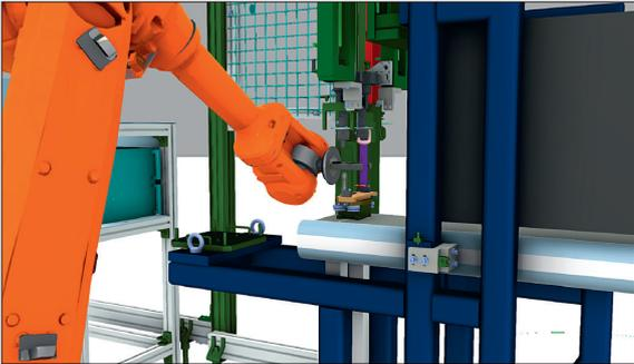
Typen- und Lagekontrolle abgebildet mit der Simulationssoftware Visual Components
