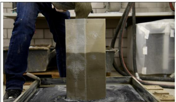
Prüfung mit Beton anhand einer Verschalung aus Recycling
