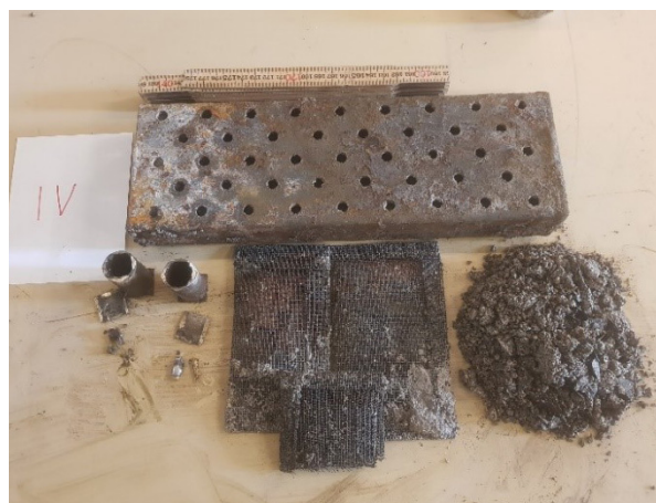
Stahlbehälter mit asbesthaltigem PVC-Boden nach dem KVA-Ofen.
