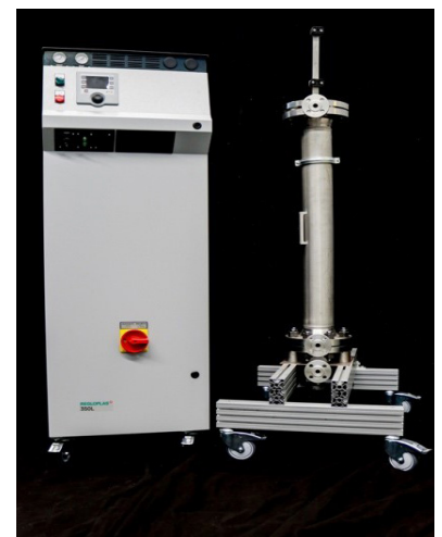
25 kW leistungsstarker Thermoöl-Umwälzthermostat (links) mit dem Reaktor (rechts).
