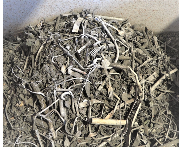
Abb. 5: Aus der Schlackenaufbereitung abgechiedene Langteile und Störstoffe.
