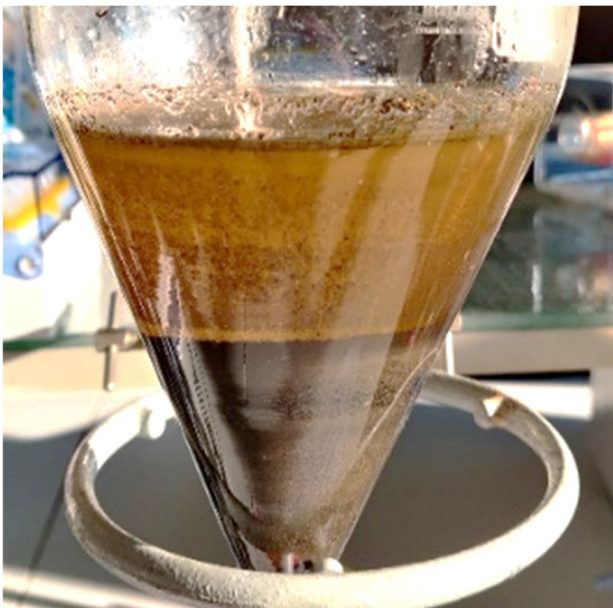
Abbildung 1: Dichtentrennung mittels Polywolframat.
