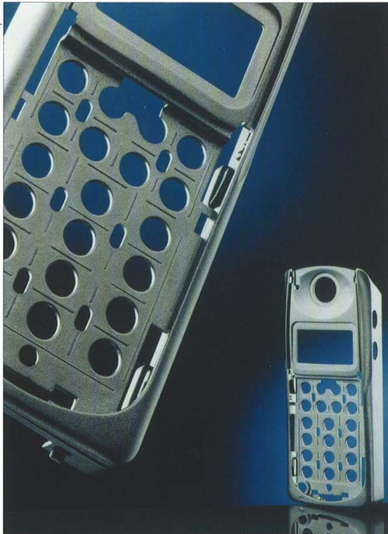
Abb. 4 (links): Kunststoffgehäuse von Mobiltelefonen, konstruiert nach dem Prinzip der Dünnwandtechnik, haben eine Wanddicke von 0,8 Millimetern und weniger, und können mit Füllzeiten unter 0,5 Sekunden spritzgegossen werden.
