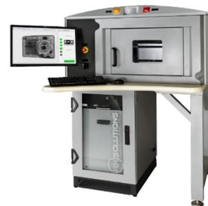
Zerstörungsfreie Untersuchung von Bauteilen mittels CT (Computertomographie)
