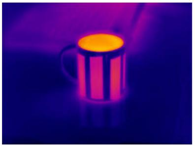
ε<sub>r</sub> → 0% bei allen blanken Metallen (Al, Cu, SnPb, Ni/Au)
