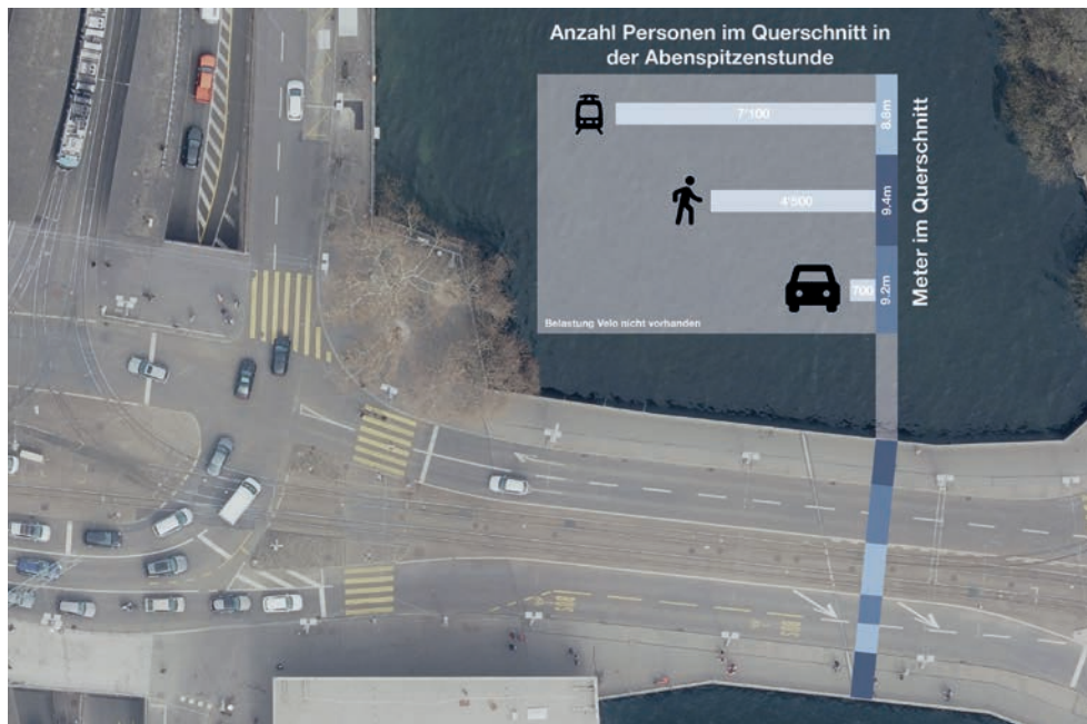
Abb. 57 Darstellung des Platzverbrauchs im Querschnitt und der Anzahl transportieren Personen für das Beispiel der Bahnhofbrücke in Zürich: Von einer Kapazitätsreduktion für den MIV wären nur wenig Personen betroffen (Besetzungsgrad MIV 1.1), Quelle: GVM-ZH18, maps.zh.ch, Aurélie Dubuis 2013
