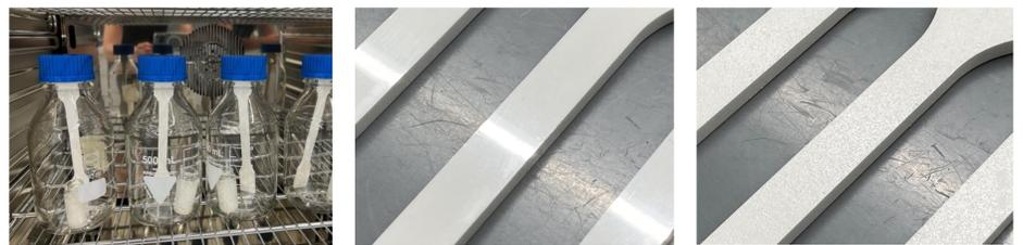
Bild 3: Einlagerung von Prüflingen bei hoher Luftfeuchte und erhöhter Temperatur, Oberfläche vor/nach der Belastung
