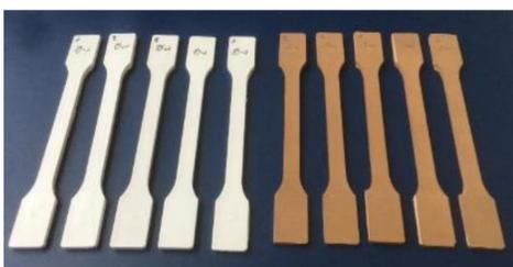
Bild 2: Zugprüfstäbe aus Vergussmasse vor (links) und nach (rechts) der thermischen Alterung im Ofen
