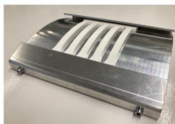
Bild 5: Halterung zur Prüfung der Spannungsrissbeständigkeit von Kunststoffen
