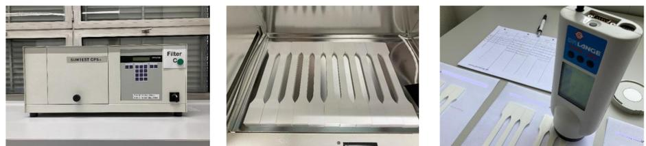
Bild 4: UV-Bestrahlungsgerät, Prüfkörper im Probenraum (mitte) und Farbmessung vor/nach Bestrahlung (rechts)
