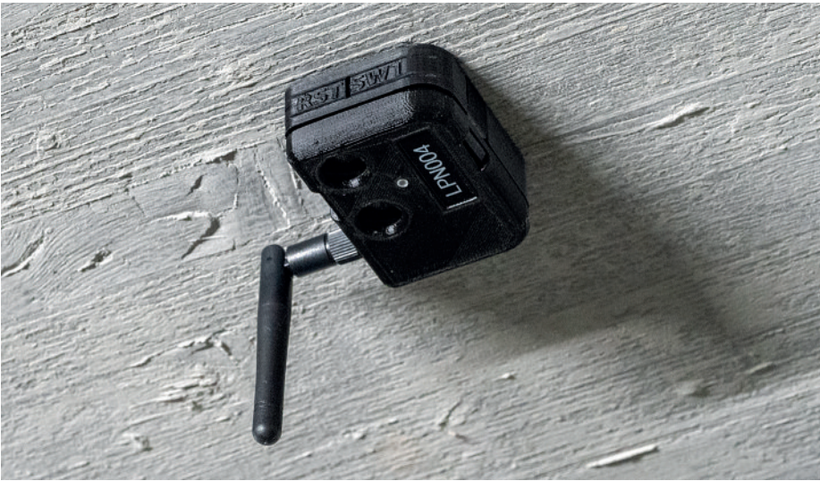
Abbildung 3: Fertiger LPN mit offenen Sensoren – es könnten jedoch auch wasserdichte, geschlossene Einheiten eingesetzt werden.
