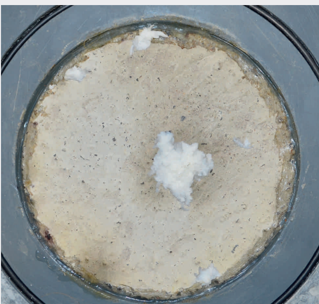
Fig. 7 Kalkablagerungen im Leitungswasser pH 7,2 auf der Seite mit Stromeintritt: links 62 mA/m 2 , rechts 189 mA/m 2
