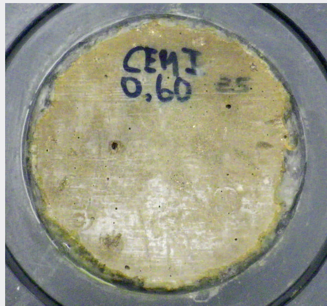
Fig. 6 Probe im Leitungswasser pH 6,4 auf der Seite mit Stromaustritt: links bei Versuchsbeginn, rechts nach sechs Monaten
