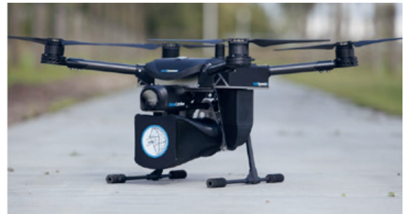
Counter-Drohne mit einem Netzwurfer DelftDynamics DroneCatcher
