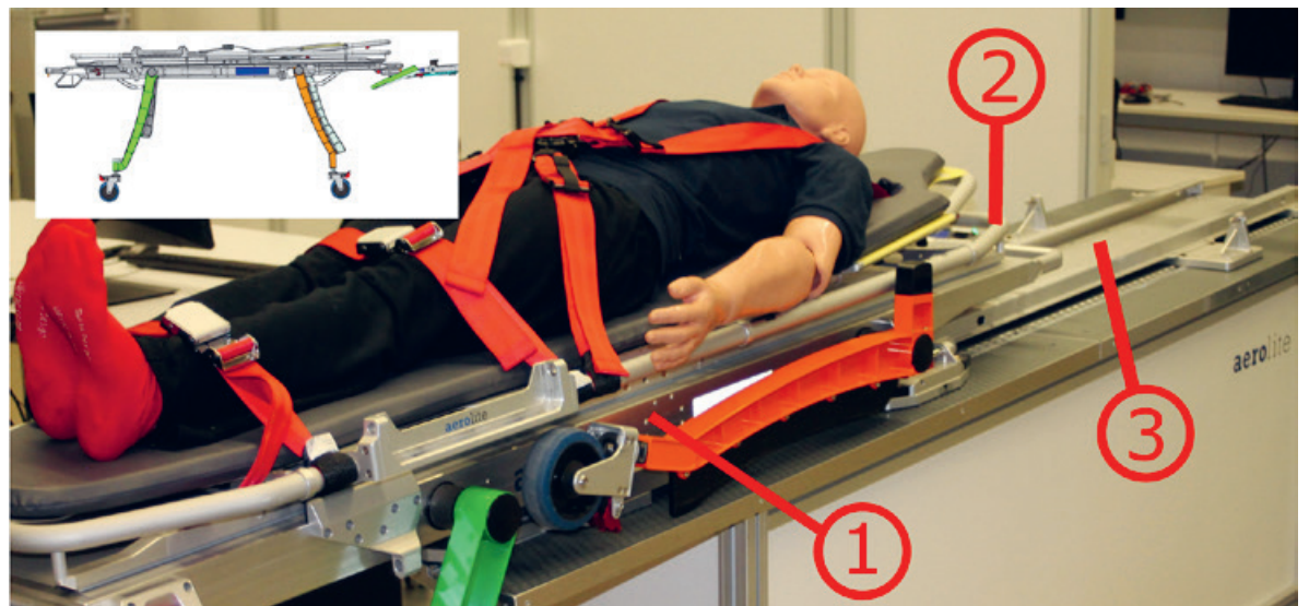
Bild 3: Manuelles System. Trolley (1) mit darauf befestigtem Stretcher (2) auf halber Strecke auf der Plattform (3). Eigene Darstellung
