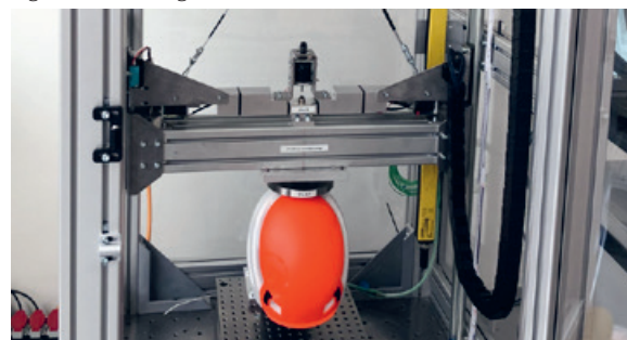
Abbildung 3: Nullpunktaufnahme am Helm Eigene Darstellung
