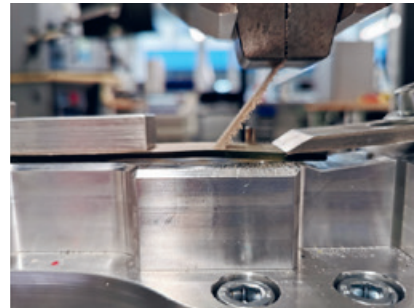
Aufgespritzter Tubus für Haftungsuntersuchungen (Zugversuch) Eigene Darstellung
