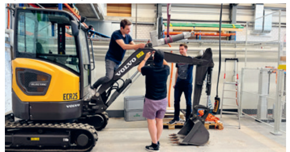
Abbildung 2: Erstmontage Prototyp noch ohne Motoreinheit Eigene Darstellung
