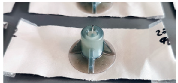
Aufgespritzter Tubus für Haftungsuntersuchungen (Zugversuch) Eigene Darstellung
