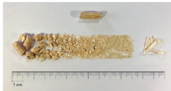
Partikelgrößen der pneumatisch geförderten Holzpellets Eigene Darstellung
