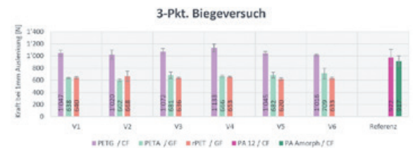
Bild 1: Kraft bei einer Auslenkung von 1 mm für die verschied. Plattengeometrie-Varianten anhand des Versuchsplans Eigene Darstellung
